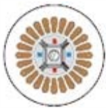
Электродвигатель с совмещенными обмотками
